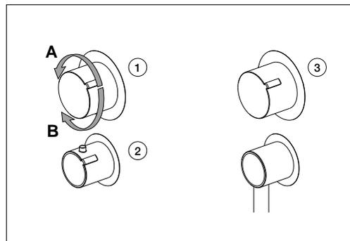
Im Fall falscher Wassertemperaturregulierung von 38°C sollte der Thermostat gem. folgender Anweisung kalibriert werden:
