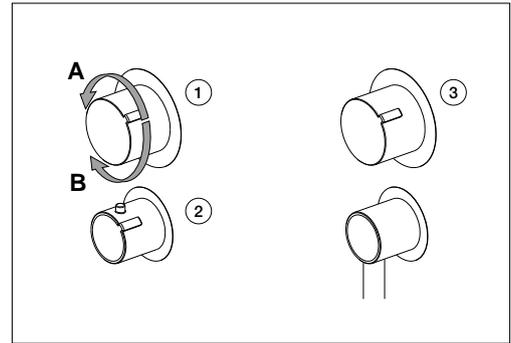
在温度控制不正确的情况下，恒温器应根据下面的说明以38°C校准：
