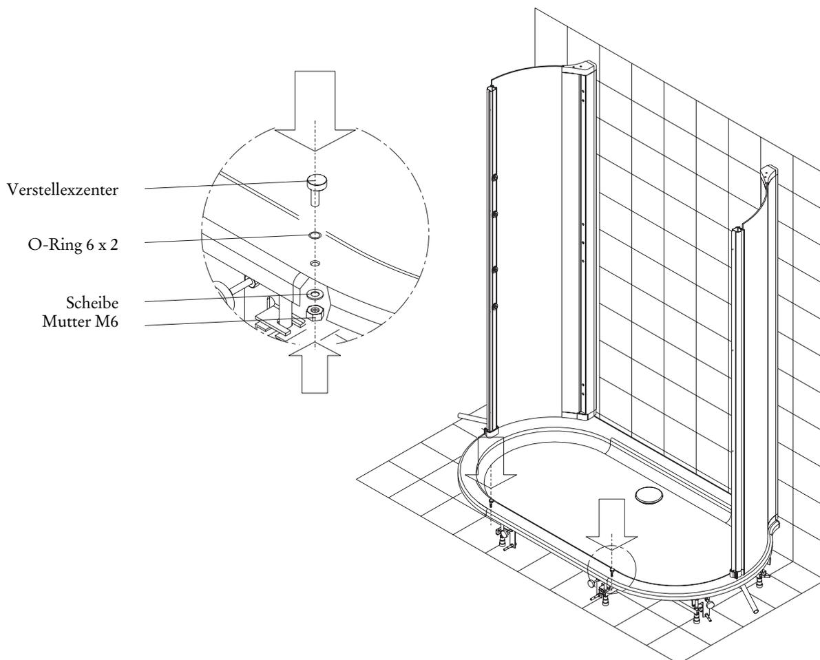
6. Silikon in die Aufnahmenut (im unteren Bereich) für die Scheibe einbringen und Zwischenelement links unten auf die Abdeckkappe aufsetzen und die Profile zusammenfügen (Achtung! Von außen darf kein Spalt sichtbar sein und die Nutenbreiten müssen identisch sein!). Dann mit 4 Blechschrauben 3,5 x 13 verschrauben und auf den Verstellzenter vorne aufsetzen. Zwischenelement rechts analog montieren.
