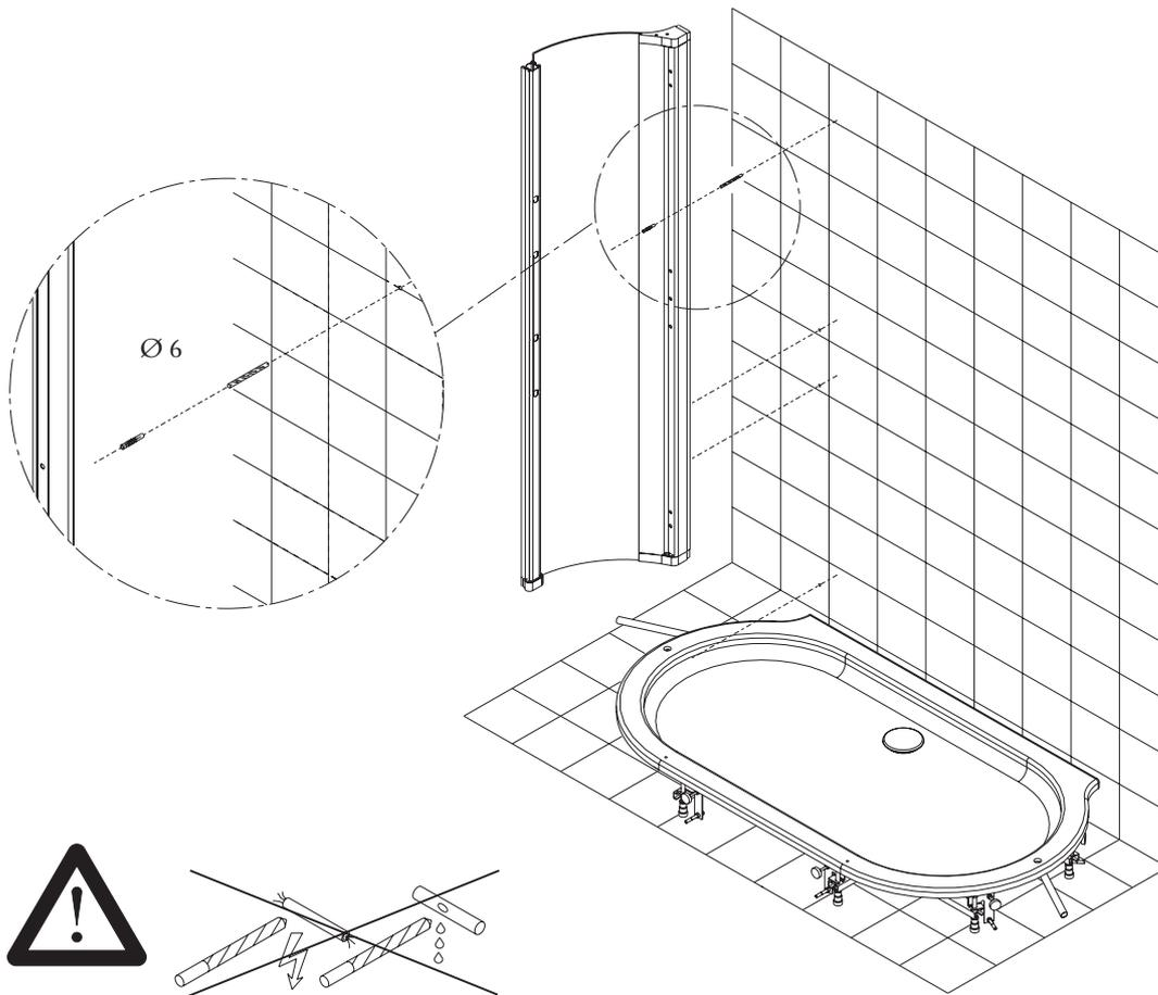
3. Seitenwand aufsetzen, Anschlussprofil verschrauben, mit Wasserwaage ausrichten und mittels Verstellerschrauben ausrichten.
