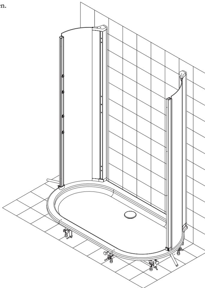
5. Verstellexzenter in die dafür vorgesehenen Bohrungen stecken. Von der Unterseite mit Unterlegscheibe und Sechskantschraube sichern und leicht andrehen.
