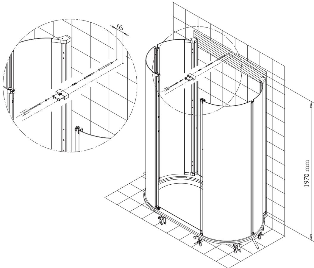
9. (1) Klebestreifen am oberen Drehpunkt der Tür entfernen (**Achtung ! Federmechanismus sichern!**). Feder kann herauspringen! Tür auf den Hub-Senkmechanismus (2) aufsetzen und den oberen Drehpunkt mit dem Federmechanismus hörbar einrasten lassen. (3) Mit Sicherungsschraube fixieren (M 5x30), diesen Ablauf an der 2. Tür wiederholen.
