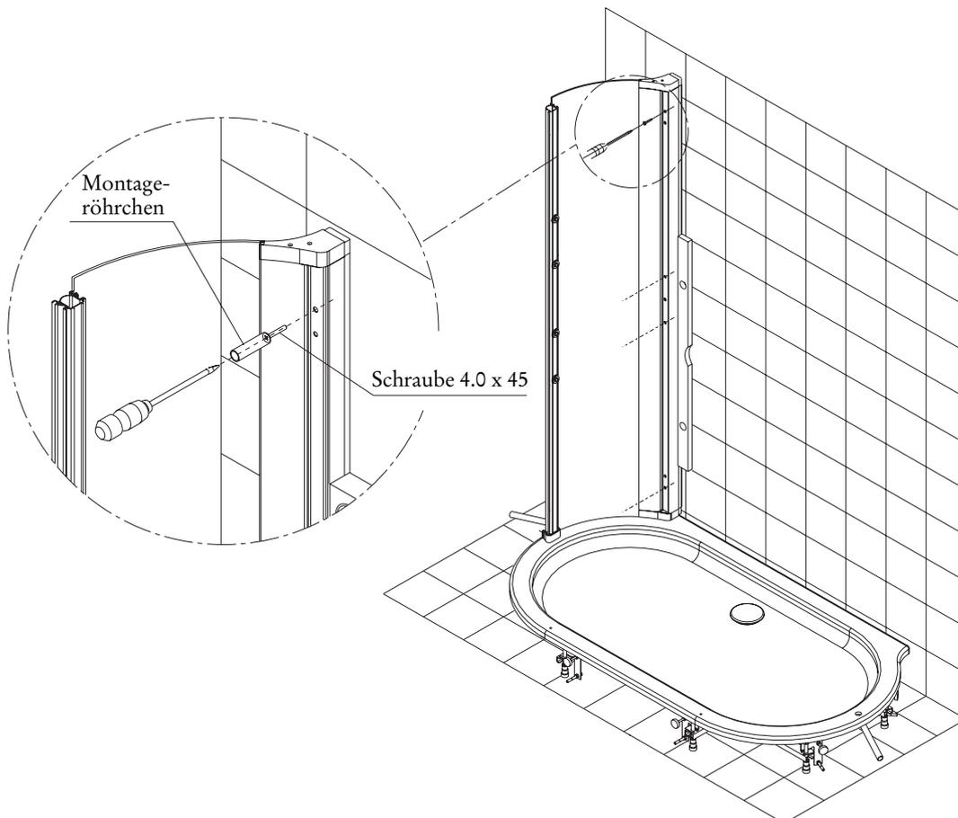
4. Seitenwand rechts analog Bild 1 – 3 montieren.
