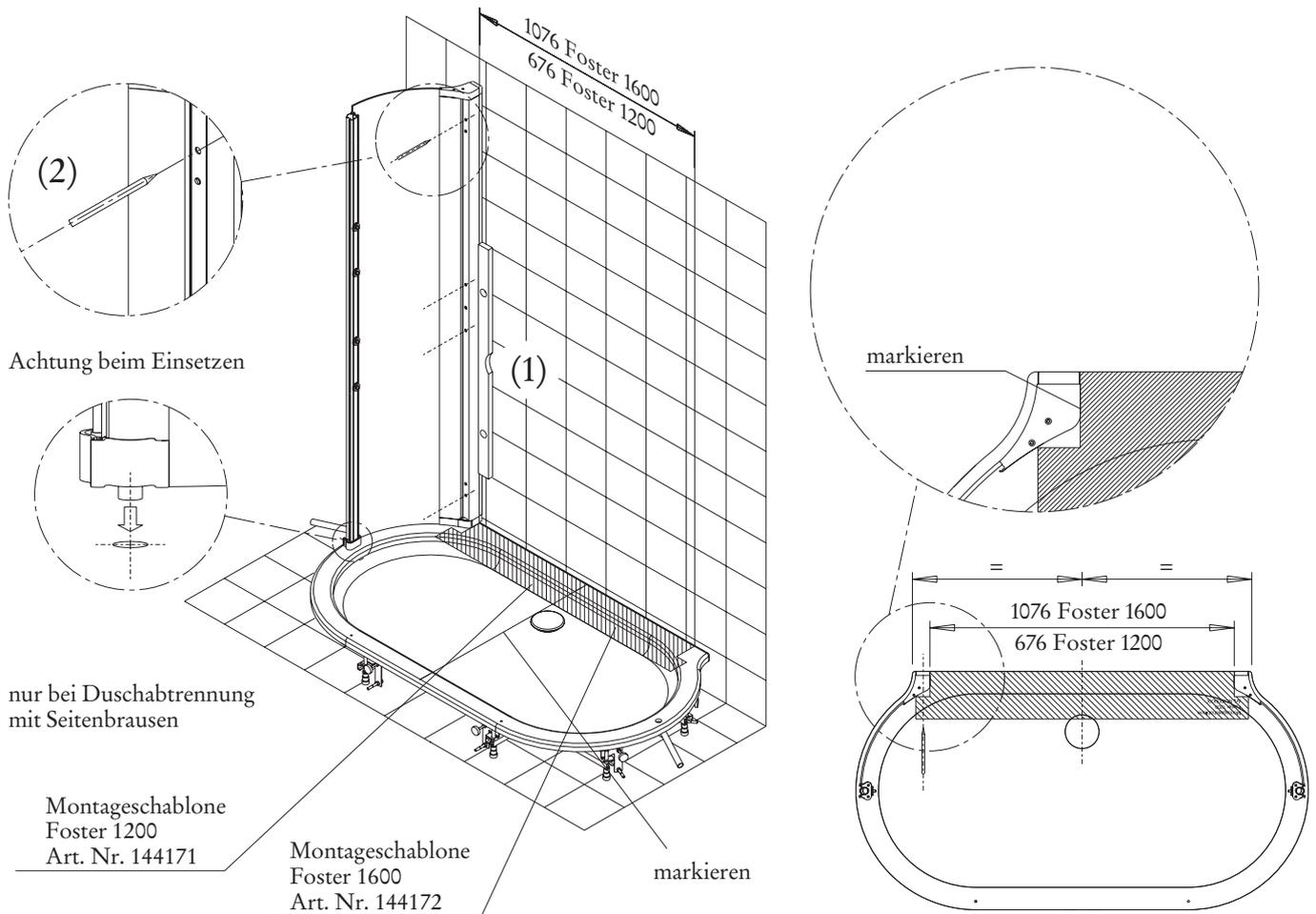
2. Seitenwand entfernen, Löcher bohren, Dübel einsetzen
