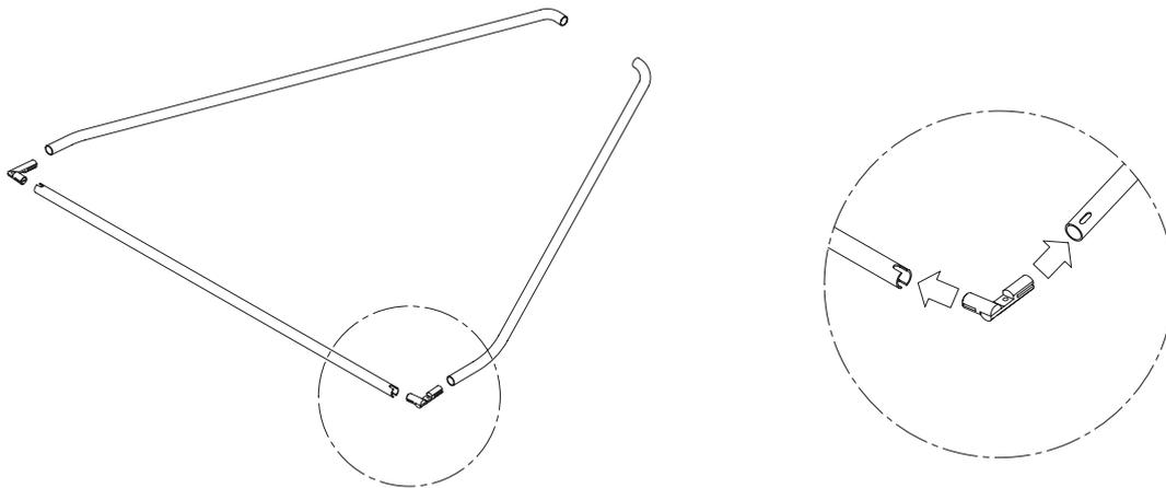
11. Vormontierte Stabilisatorrohre hinten in Wandbefestigung (1) einstecken und mit Schrauben fixieren, vorne von oben in die Schanierkappen (2) einlegen. Abdeckkappen (3) aufsetzen und verschrauben. Duschtrennung so ausrichten, dass der Magnetzusammenschluss parallel verläuft und in Waage ist (4). (Ausrichtung oben über Querstabilisator, Ausrichtung unten über Verstellexzenter). Nach erfolgreicher Justage des Seitenteils, Schrauben festdrehen und Kontermutter des Verstelllexzenter festziehen!
