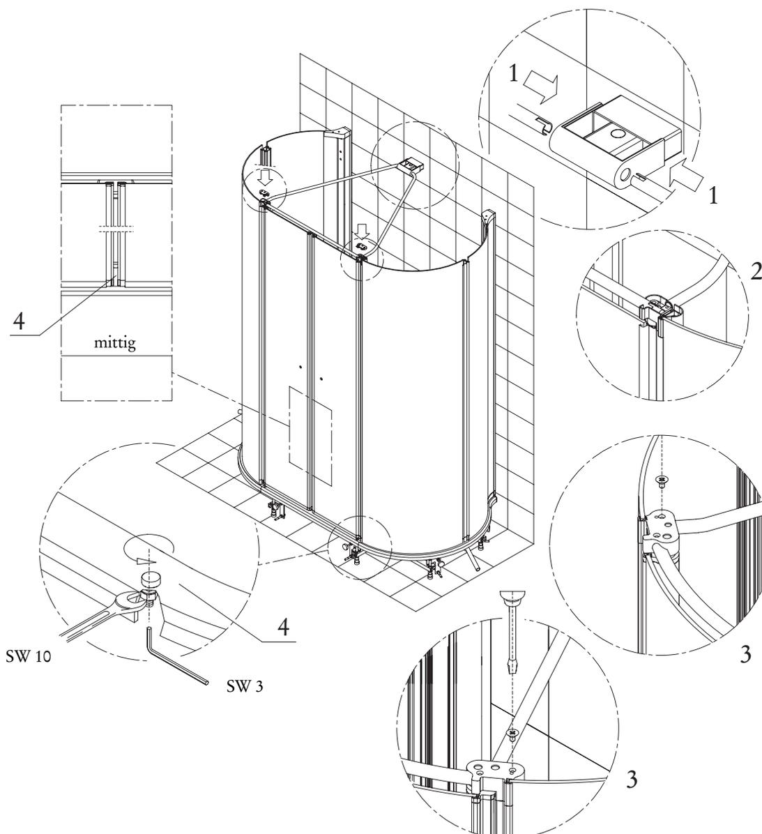
12. Nachjustieren über Stellschrauben (1) ist möglich. Abdeckklappe (2) aufstecken.
