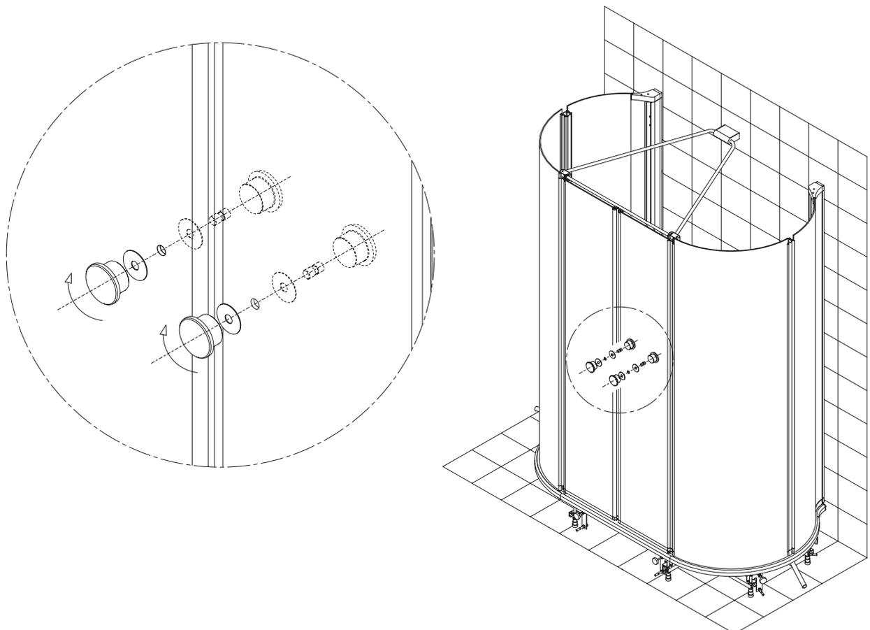
14. Anschluss Seitenbrause fest verschrauben. (Nur bei Duschabtrennung mit Seitenbrausen).
